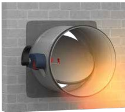
Tekib tulekahju ja temperatuur tõuseb 72 kraadini. Tuleiiber sulgub.
